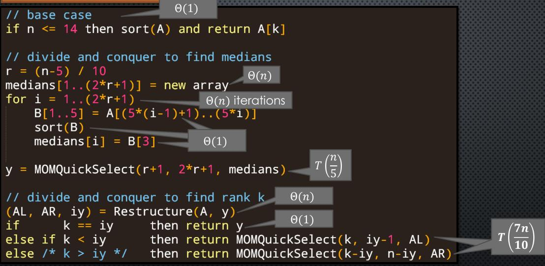
$T(n) \in O(n) + T(n/5) + T(7n/10)$ if  $n \ge 15$  $T(n) \in O(1)$ if  $n \le 14$
